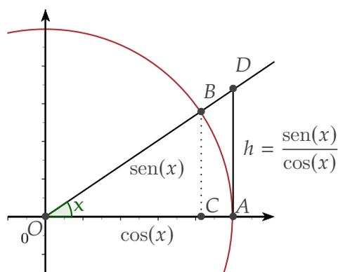
conforme apresentado na figura ao lado, como os triângulos  $\triangle OCB$  e  $\triangle OAD$  são semelhantes, se denotarmos por  $h$  o tamanho do segmento  $AD$ , por semelhança de triângulos temos que
