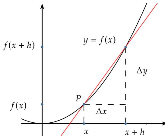
Intuitivamente, temos que conforme o ponto  $Q$  se aproxima do ponto  $P$  temos que a inclinação da reta secante por  $P$  e  $Q$  se aproxima da inclinação da reta tangente a  $f$  no ponto  $P$  e no "limite" é igual a inclinação. Assim temos:
